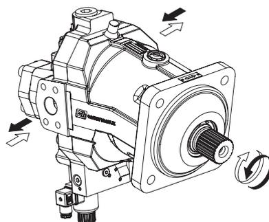
Il regolatore "ROE" consente la variazione della cilindrata in un campo maggiore di pressione rispetto al regolatore "RPE". L'aumento del campo di pressione per la variazione dalla  $V_{g_{min}}$  alla  $V_{g_{max}}$  consente un comportamento più dolce e graduale del motore durante la variazione. Il regolatore "ROE" consente la variazione della cilindrata con campi di pressione indicati in tabella.
