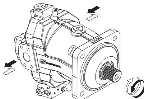
Il regolatore elettromagnetico a due posizioni permette di regolare la cilindrata del motore tra  $Vg_{max}$  e  $Vg_{min}$  intervenendo sull'alimentazione di un magnete ON/OFF. La mancanza della molla di retroazione consente di ottenere solo le due cilindrature estreme ( $Vg_{max}$  e  $Vg_{min}$ ).
