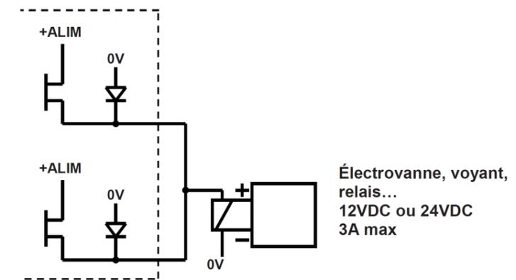
Les électrovannes proportionnelles commandées par les sorties vanne Y+, Y-, X+ et X- sont asservies en courant, la tension d'alimentation et la température n'ont donc pas d'influence sur l'ouverture de l'électrovanne :
