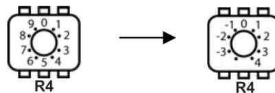
**123 Hz** : R1 sur la position 1, R2 sur la position 2, R3 sur la position 3, R4 sur la position 0 :
