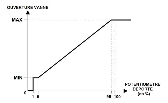
Réglage de l'ouverture MIN : Positionner le potentiomètre de consigne à 0 (butée lorsque que l'on tourne le potentiomètre dans le sens anti-horaire). Puis tourner le légèrement dans l'autre sens jusqu'à ce que la led clignote. Régler l'ouverture minimale avec le potentiomètre MIN de la face arrière.
